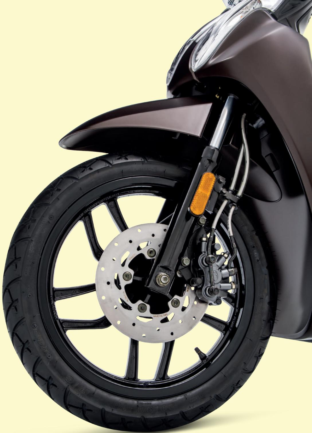
Cuando se quiere todo, el camino es largo, por eso necesitamos la máxima seguridad. Las llantas del Miler 125 son de gran diámetro (16 y 14 pulgadas) dándole al conductor toda la estabilidad que necesita. Además, su disco delantero y trasero permiten tener el control total al circular, y su sistema de frenos CBS con latiguillos de trenzado metálico es perfecto en situaciones de emergencia, pues no se ve afectado por sobrecargas de presión. Control total para que ningún imprevisto lo detenga.
