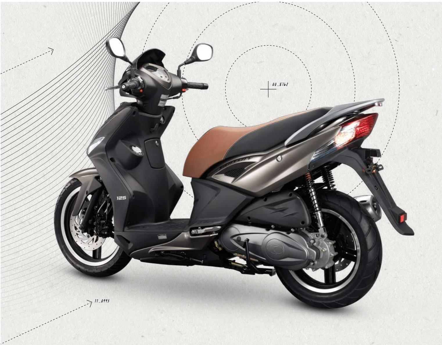
**Estabilidad.** El diseño de su bastidor ha permitido reubicar el depósito de 7 litros bajo el suelo plano, bajando sensiblemente su centro de gravedad. Su llanta trasera de 14" con perfil pulido, los neumáticos de anchas dimensiones y el basculante trasero de aleación aligeran el peso y aumentan la rigidez del conjunto y la estabilidad del vehículo.
